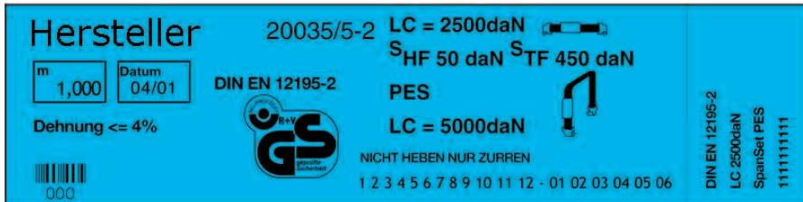
Beispiel eines Zurrgurtetikettes gemäß der DIN EN 12195-2
