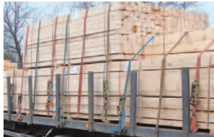
Zweiteilige Zurrgurte werden hauptsächlich zum Niederzurren eingesetzt.
