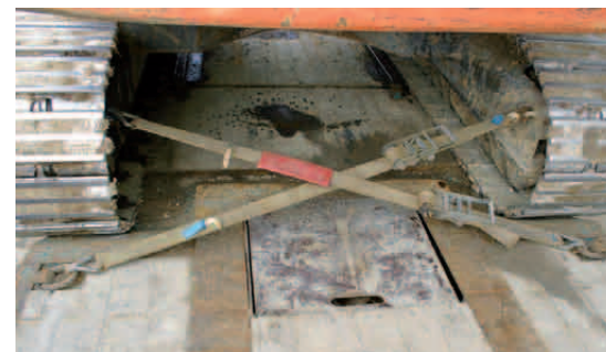
Verwendung von Schwerlastgurten zum Diagonalzurren.
